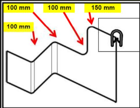
Rayon de courbure sur tole de : / Bending Radii with edge thickness :
